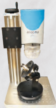
Система Alicona EdgeMaster со специальным штативом компании «PLATIT» Источник: компания «Alicona», Грац, Австрия
