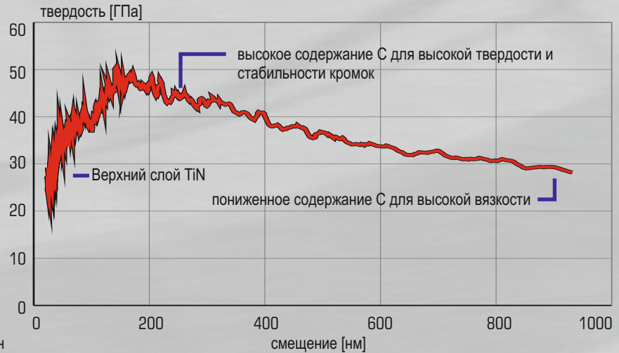
Индентирование наноградиентного покрытия без трещин
