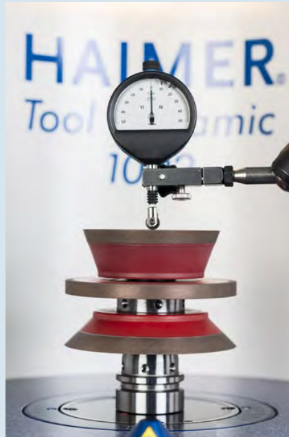
Planlaufprüfung/Axial runout check
