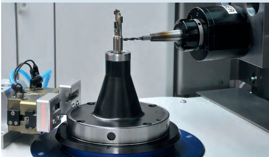
Auswuchten von Werkzeugen mit Hilfe des HG-Wuchtadapters für Schaftwerkzeuge
