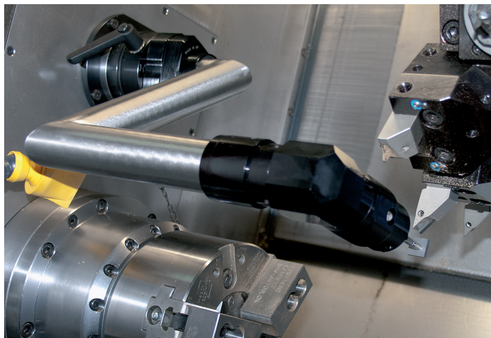
Съёмная инструментальная измерительная система Absetzbares Werkzeugmesssystem RENISHAW Removable RENISHAW tools measuring system
