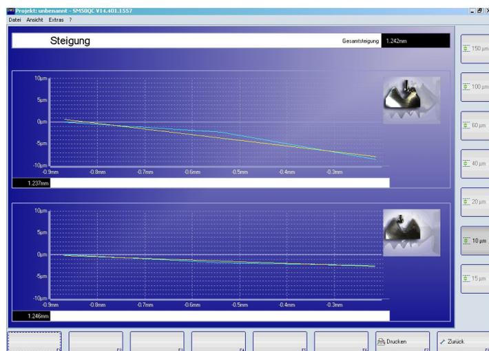
Фото: Измерение шага резьбы
