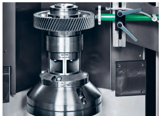
Werkstückwechsel und Einmitten ausserhalb des Arbeitsraums
