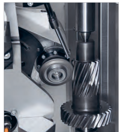
Profilschleifen mit Profilschleifkopf
