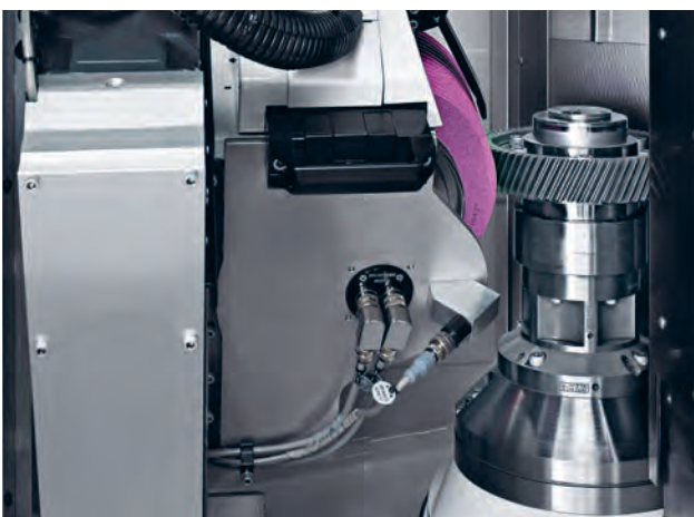
Werkstück in Schleifposition
