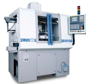
M628 Spezialmaschine zum Fräsen der selbstschneidenden Nuten an Medizinalschrauben
