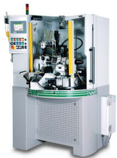
W90 CNC (Handladung) Feinverzahnungsmaschine ■ Modul 0.05 - 1 mm
