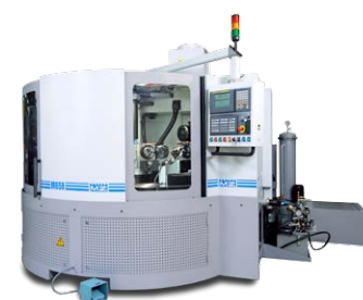
M658 2-Stationen Poliermaschine für Ku- geln und Kalotten
