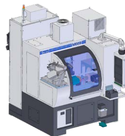
M669 Kopf- und Spitzenwirbelma- schine für Medizinalschrau- ben
