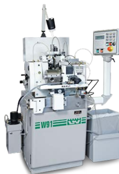
W91 Feinverzahnungsmaschine ■ Modul 0.05 - 1.5 mm
