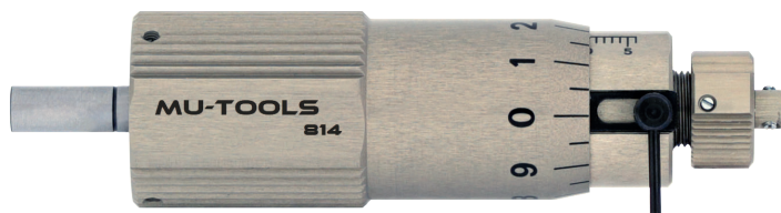
Hand-Hongerät MU-TOOLS 814 für \varnothing 0,6 bis 1,4 mm
