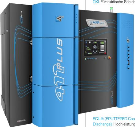
SCIL® (SPUTTERED Coating Induced by Lateral Glow Discharge): Hochleistungs-SPUTTERING aus der zentralen Kathode, u. a. für ta-C-Beschichtungen Hybrid-LACS®: simultane ARC- & SPUTTER-Prozesse mit LARC®-Kathoden in der Tür und zentraler SCIL®-Kathode
