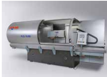
FLS Fahrständerbauweise bis 800 mm Schleifbreite
